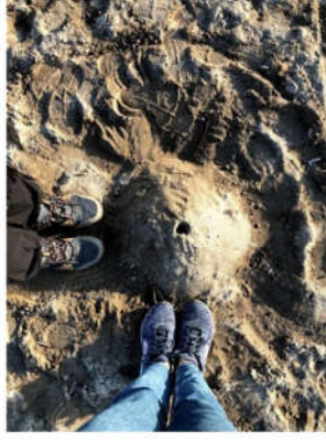
Şekil 5.7 a) Sıvılaşma gözlemlenmemiş bir kumsal örneği (38.057442, 27.011747) b) İki farklı sahilden kum kaynaması örnekleri (38.338447, 26.647494 ve 38.310372, 26.679756)
